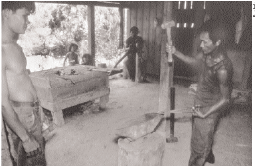
Schmiede im Heks-Projekt: Aus Bombensplittern werden Hacken hergestellt.
